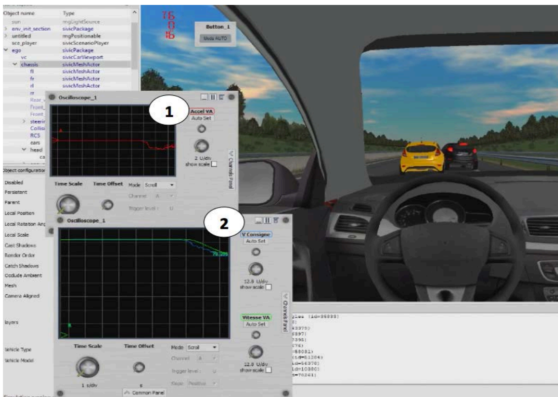
Figure 21 : Réaction du VA VEDECOM (freinage) lors de la survenue d'un accident de COSMODRIVE
