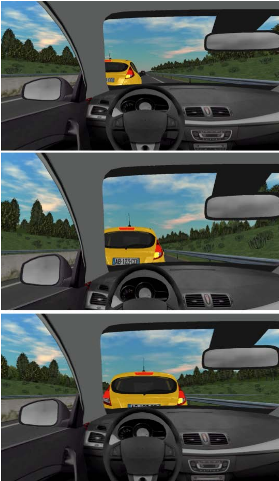
Figure 18 : Simulation d'une erreur de conduite typique des conducteurs âgés, lorsque ceux-ci ont des difficultés pour apprécier les distances des autres véhicules via leurs rétroviseurs, en situation de rattrapage sur voie rapide
