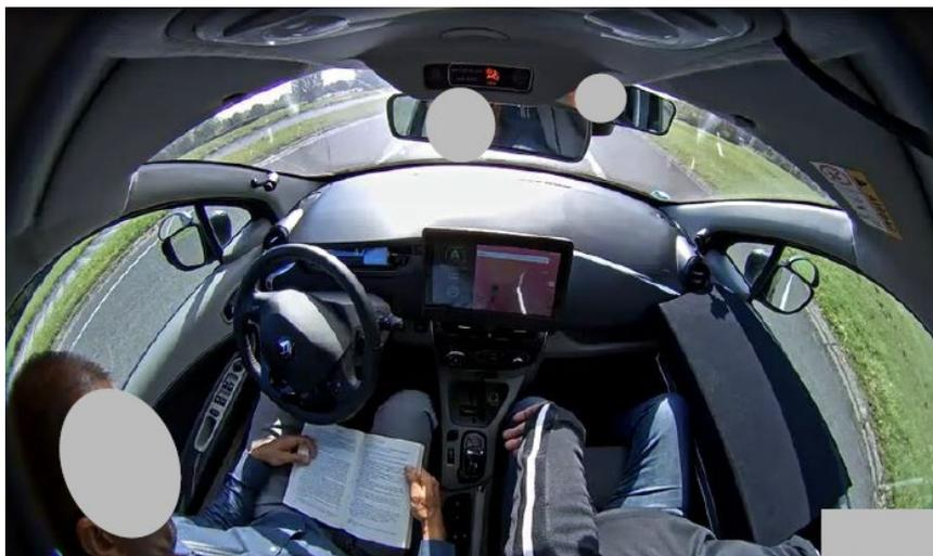
Figure 31. Intérieur du véhicule Renault Zoé équipé du dispositif WOZ avec, à gauche, un conducteur réalisant une activité autre que la conduite, et, à droite, un passager, contrôlant le véhicule via un joystick dissimulé dans la portière.
